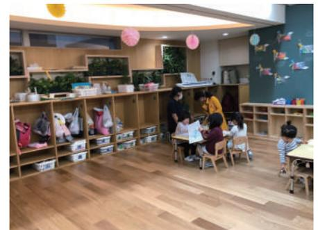
■ 1階保育室のみどりパレット壁面植栽は、2面の壁に、長さ0.6m～1mのプランター1基～3基をランダムに組み合わせ、葉色・形状の異なる観葉植物を配置しました。それぞれのプランターには、壁、ロッカーと同じデザインの木製枠を取り付けてあります。養液は溜め水方式です。
