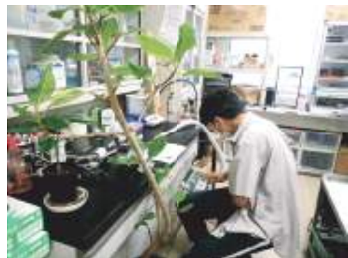
世界標準機器として利用されている 光合成測定装置Li-6400XT 後継機種Li-6800は2000万円
